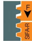
Il carico è rilevato dalla chiocciola Duplex. Il controdado di sicurezza scorre senza carico con la chiocciola Duplex. In caso di rottura del filetto della chiocciola in seguito ad usura, il sistema SIFA ne rileva il carico.
