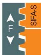
Il carico viene sostenuto dalla vite della ruota dentata. In caso di rottura del filetto nella ruota dentata in seguito ad usura, il sistema SIFA ne rileva il carico. Il carico viene tenuto.
